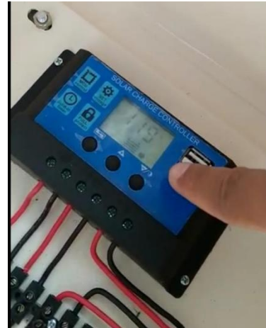
Gambar 7. Tampilan Solar Charge Controller pada Saat Mengeluarkan Energi untuk Menghidupkan Lampu
