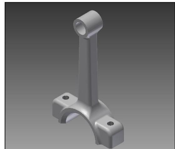
Gambar 3. Desain 3 dimensi batang piston
