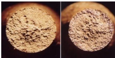
(a) quench pada 840°C (b) quench 840°C, temper 200°C
