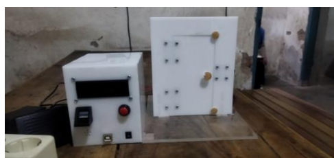
Gambar 2. Alat Smart Lockdoor dengan Sensor Fingerprint dan Modul Bluetooth berbasis Arduino Mega
