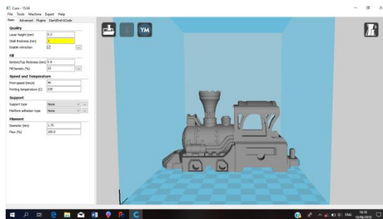
Gambar 2. Pengaturan dimensi menggunakan aplikasi Cura
