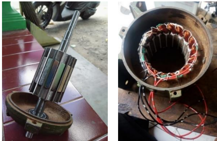
Gambar 4. Gambar stator dan rotor PMSG 18S16P
