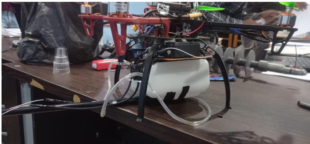
Gambar 4. Rangkaian pemantik Api pada Drone
