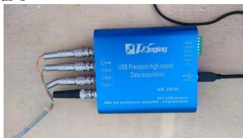
Gambar 4. Setup Susunan kabel data di terminal VK-701H
