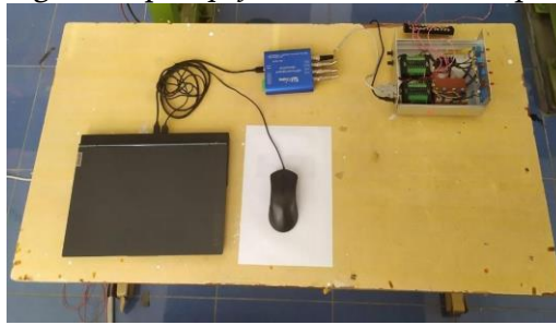
Gambar 6. Set up amplifier dan VK-701H
