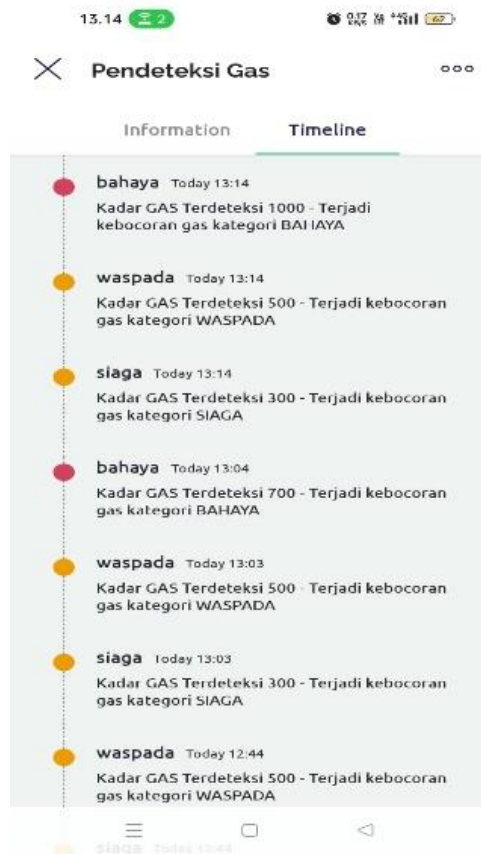
Gambar 8. Pengujian Tampilan Notifikasi Pesan (Blynk)
