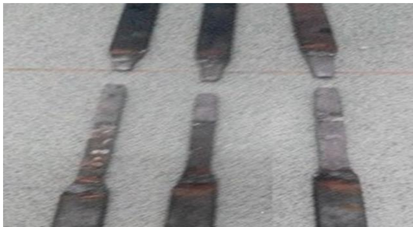
Gambar 4. Spesimen putus setelah diuji tarik
