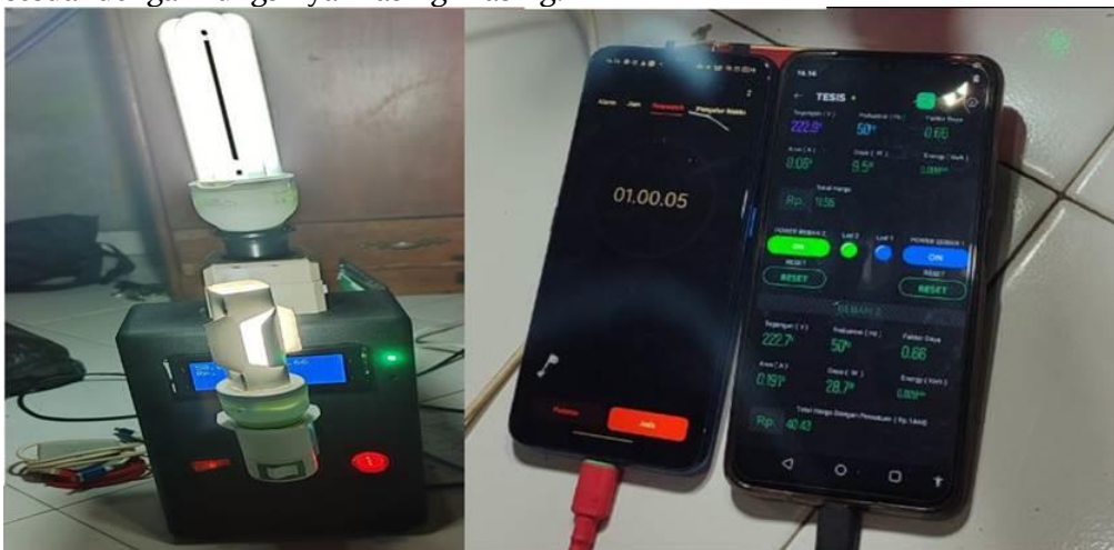
Gambar 9. Hasil Pengukuran Lampu 32W dan 18W dalam satu jam
