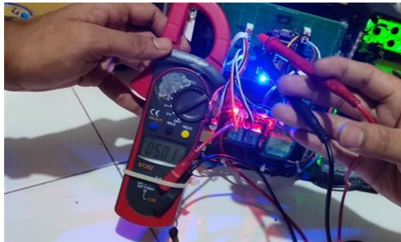
Gambar 7. Pengujian Tegangan Kerja Modul PZEM-004T
