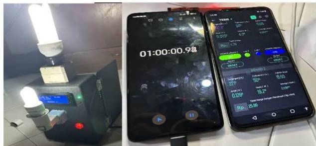
Gambar 8. Hasil Pengukuran Lampu 5W dan 18W dalam satu jam
