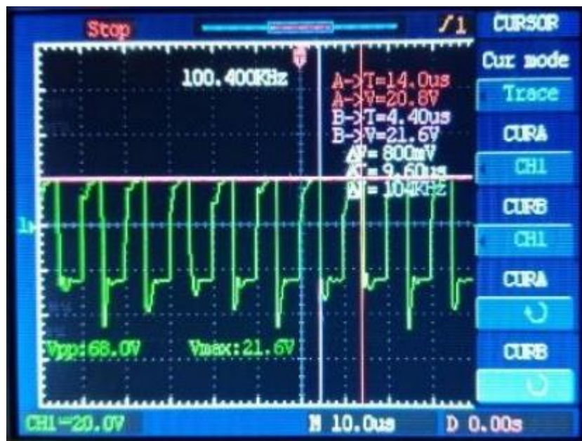
Gambar 3. Output dari rangkaian inverter pada frekuensi 100 kHz
