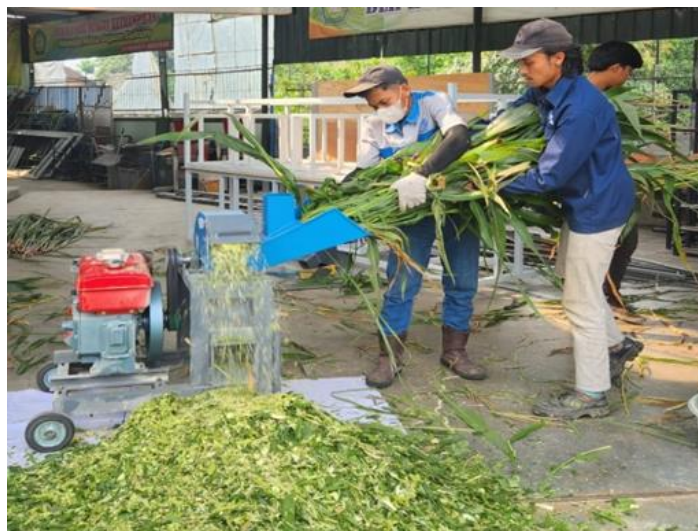
Gambar 2. Proses Uji Coba Pencacahan Pakan Rumput Hijauan
