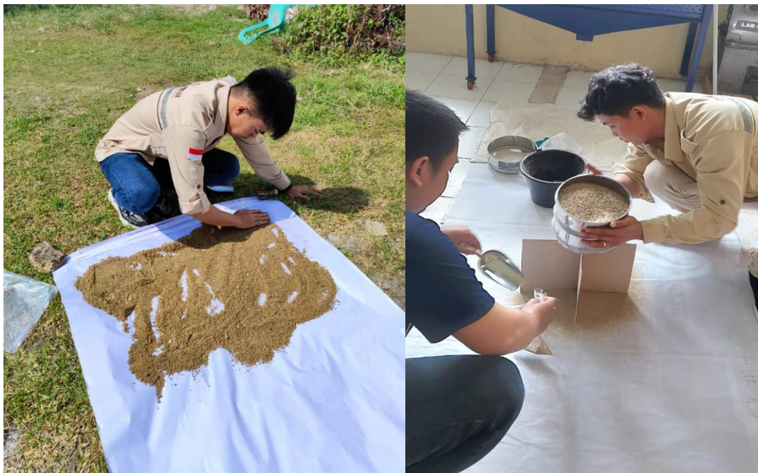
Gambar 3. Preparasi Sampel dengan Penjemuran dan Metode Quatering
