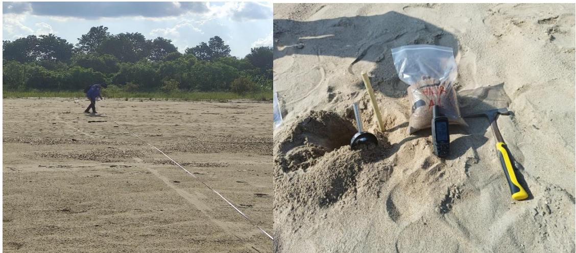
Gambar 2. Pengambilan Sampel Metode Grab Sampling Dengan Pola Grid
