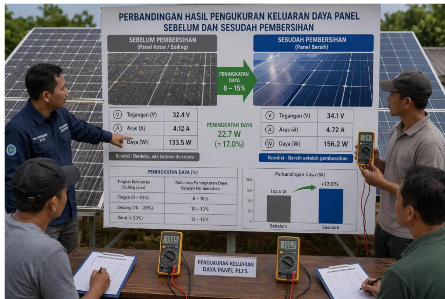
Gambar 5. Perbandingan hasil pengukuran keluaran daya panel sebelum dan sesudah dilakukan pembersihan.
