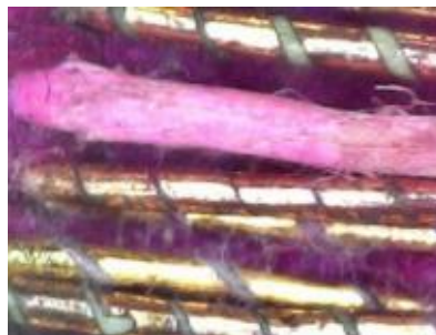
Gambar 5. Gambar Benang Emas yang Rusak Hasil Perekaman Mikroskop Digital Portable
