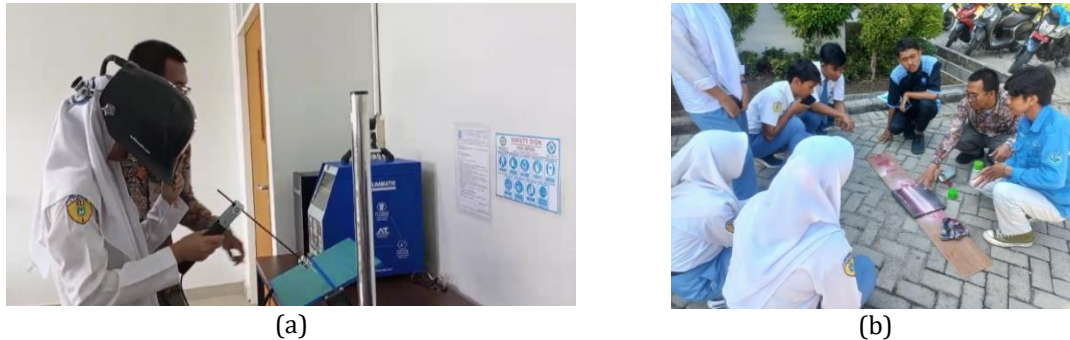
Gambar 8. Pelaksanaan praktik oleh tim dosen dan mahasiswa JTK Poltera (a) praktik pengelasan di mesin las AR; (b) praktik penetrant test
