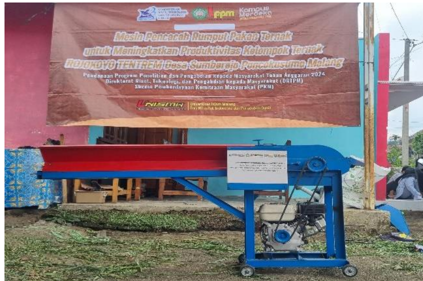
Gambar 6. Mesin Pencacah Rumput Pakan Ternak
