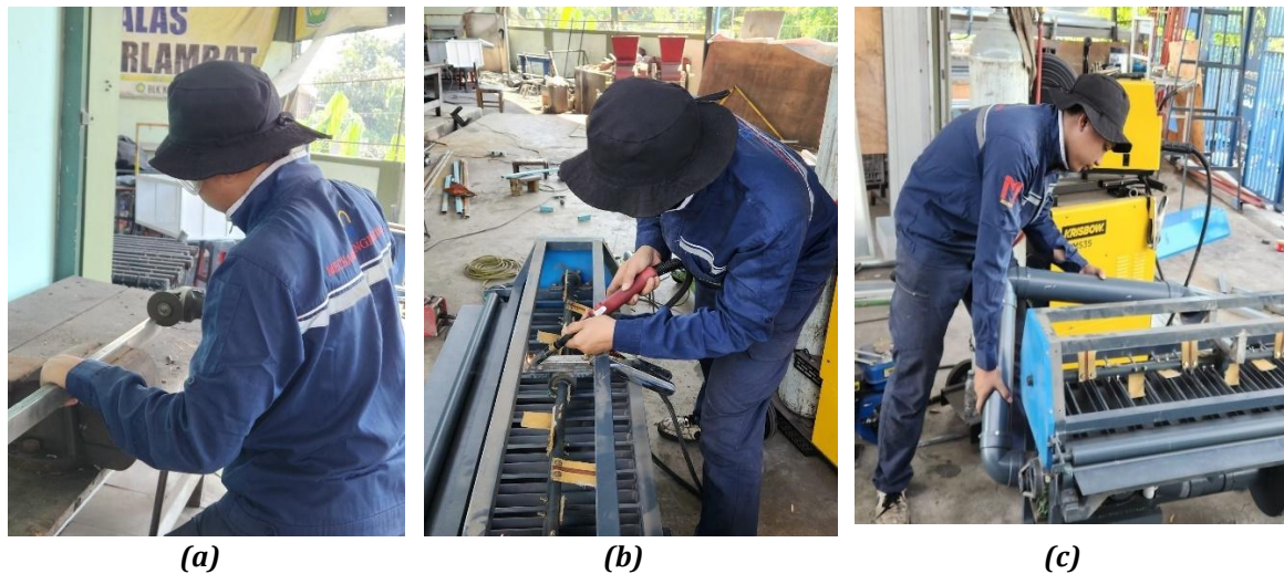
Gambar 1. (a) proses pemotongan bahan, (b) pengelasan kerangka Dan (c) perakitan/penyetelan komponen Mesin Pembersih Karpet Tipe Pemukul (Hitter)
