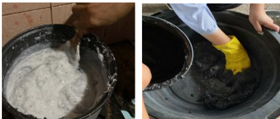
Gambar 12. Proses pencampuran bahan briket
