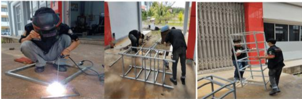
Gambar 4. Proses Pengelasan Rangka Alat Pengering Ikan Asin
