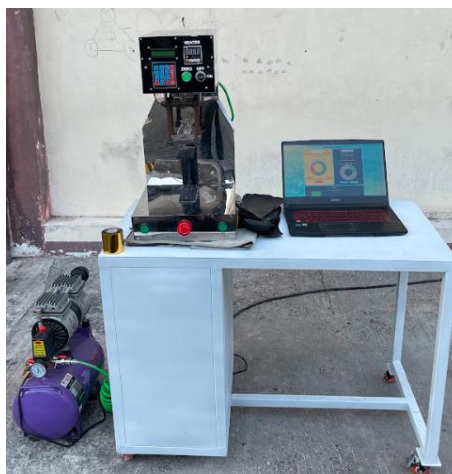
Gambar 4. Tampak fisik mesin sepatu hot embossing pneumatik otomatis dilengkapi cloud computing
