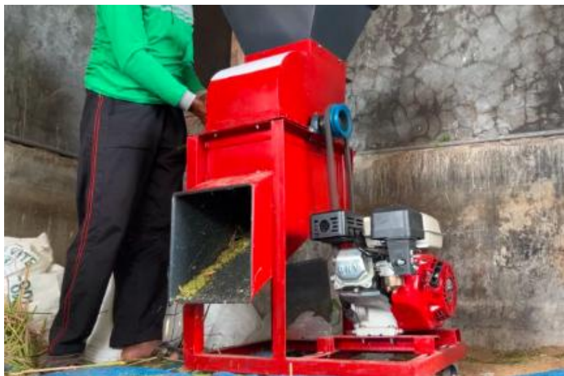
Gambar 5. Mesin Pencacah Serbaguna Dengan Double Input
