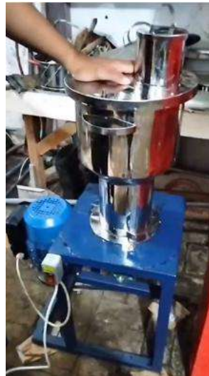
Gambar 4. Uji fungsi awal sistem transmisi dan tabung penghalus
