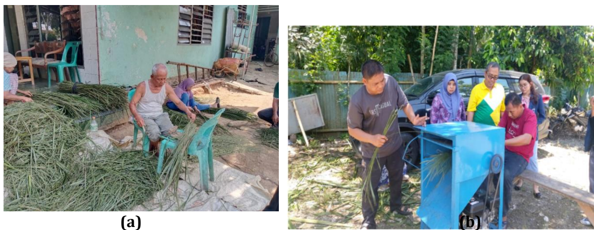
Gambar 4. Kegiatan pemisahan lidi sawit : (a) dengan manual; (b) menggunakan teknologi mesin
