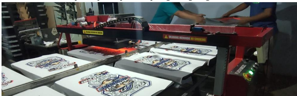
Gambar 5. Proses pengeringan menggunakan flash curing gas autoslide
