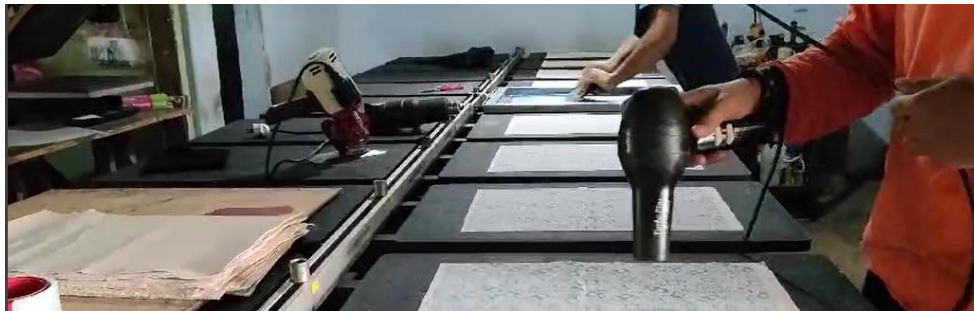
Gambar 2. Pengeringan manual sebelum menggunakan flash curing gas autoslide ( hot gun )
