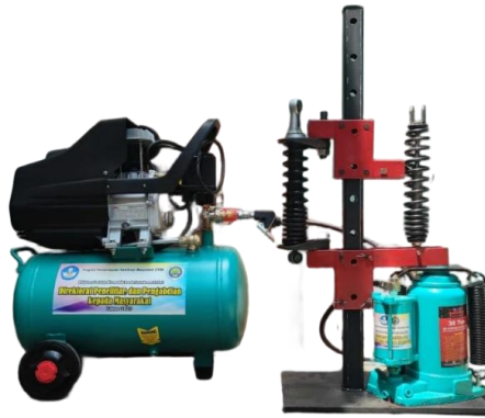
Gambar 2. Kelengkapan alat bongkar shockbreaker dengan sistem hidrolik dan pneumatik dengan menggunakan kompresor
