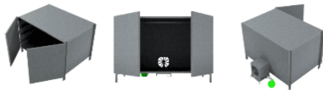
Gambar 1. Desain ruangan pengering batik
