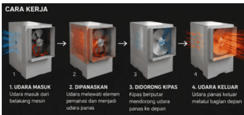
Gambar 3. Cara kerja mesin blower
