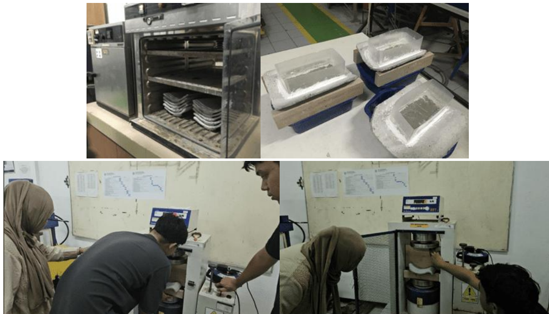
Gambar 10 Pengujian mutu genteng beton berdasarkan parameter SNI 0096:2007 di laboratorium
