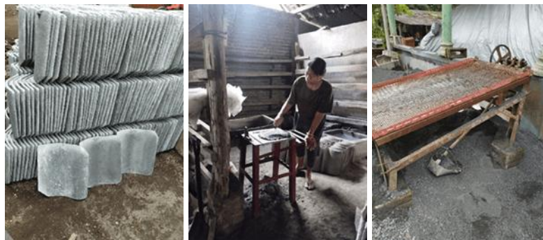
Gambar 2 Hasil Produk, proses pembuatan, dan alat pembuatan Genteng Mitra
