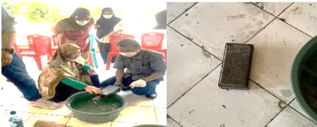
Gambar 5. Hasil Paving Block menggunakan limbah plastik setelah perendaman
