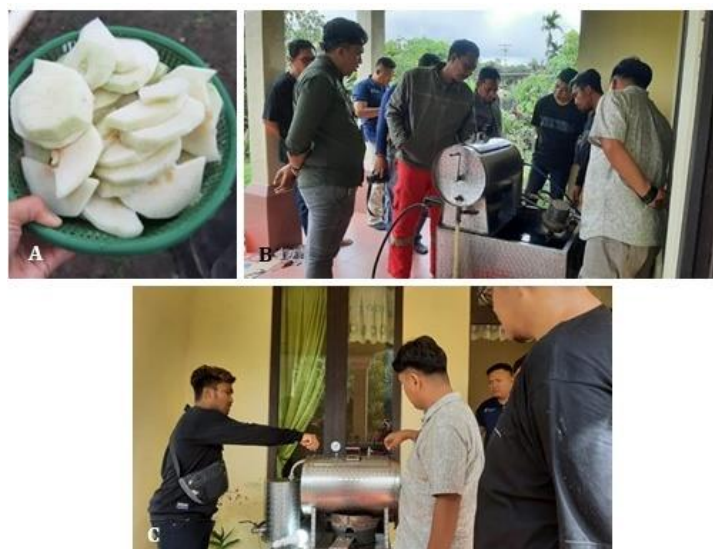
Gambar 4. Demonstrasi dan Praktik Pembuatan Keripik Jambu Kristal, A. Jambu Kristal yang telah diiris, B. Demonstrasi Penggorengan Jambu Kristal dalam Vacuum Frying oleh Narasumber, C. Peserta Praktik mengoperasikan alat Vacuum
