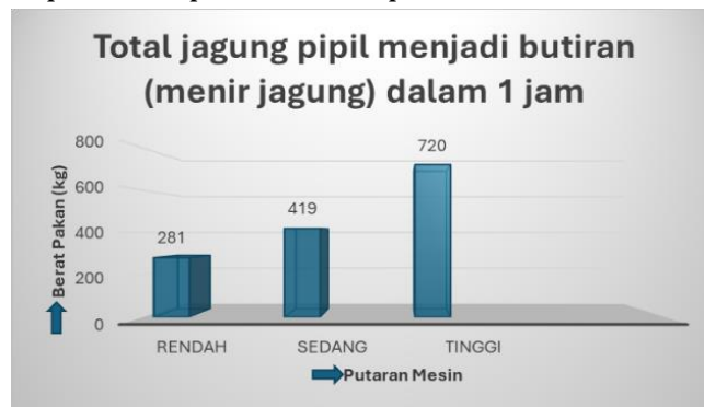
Gambar 7. Total Jagung Pipil Menjadi Butiran (Menir Jagung) dengan Diameter 4mm yang Dihasilkan Mesin Bekerja Bekerja selama 1 Jam dalam putaran rendah (1200-1500) rpm, putaran sedang (1600-2000) rpm, dan putaran tinggi (2200-2600) rpm
