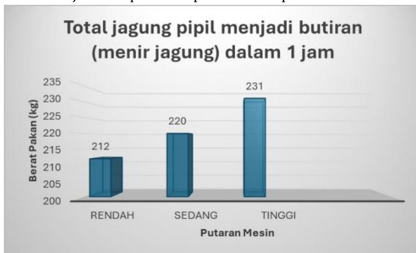
Gambar 6. Total Jagung Pipil Menjadi Butiran (Menir Jagung) dengan Diameter Saringan 2mm yang Dihasilkan Mesin Grinder bekerja selama 1 Jam dalam putaran rendah (1200-1500) rpm, putaran sedang (1600-2000) rpm, dan putaran tinggi (2200-2600) rpm .
