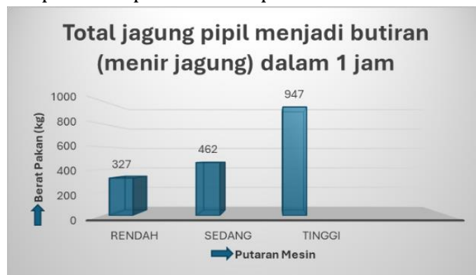
Gambar 8. Total Jagung Pipil Menjadi Butiran (Menir Jagung) dengan Diameter 6mm yang Dihasilkan Mesin Grinder Bekerja Selama 1 Jam dalam putaran rendah (1200-1500) rpm, putaran sedang (1600-2000) rpm, dan putaran tinggi (2200-2600) rpm
