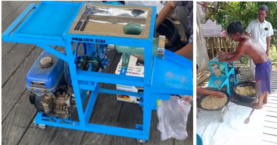
Gambar 3. Mesin pencetak pellet dan hasil pellet
