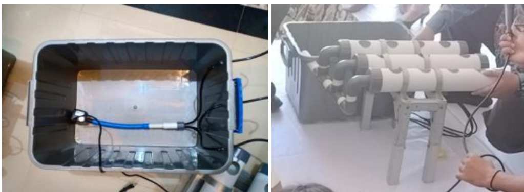
Gambar 1. Instalasi Hidroponik dengan Tandon dan Sistem Pompa
