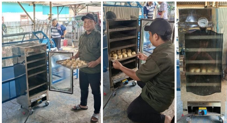
Gambar 2. Uji Coba Hasil Rancang Bangun Teknologi Dimsum Steamer
