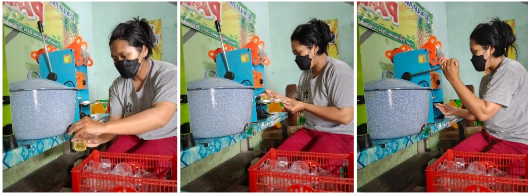
Gambar 2. Proses penyegelan menggunakan sealer konvensional
