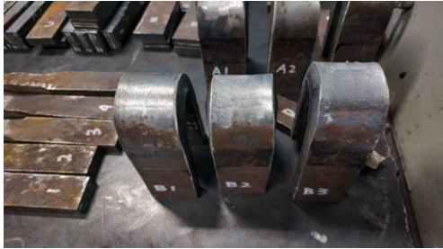
Gambar 20 Hasil uji bending pengelasan repair 1x
