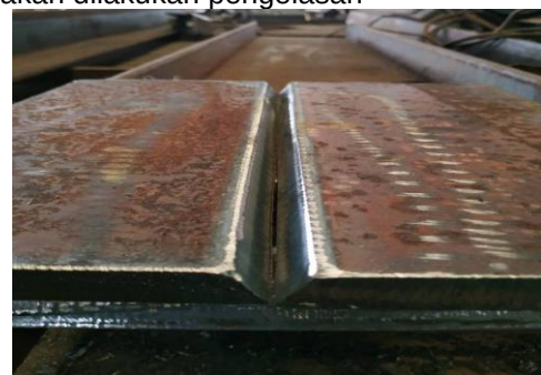
Gambar 2 Plat 15 sudah bevel V
