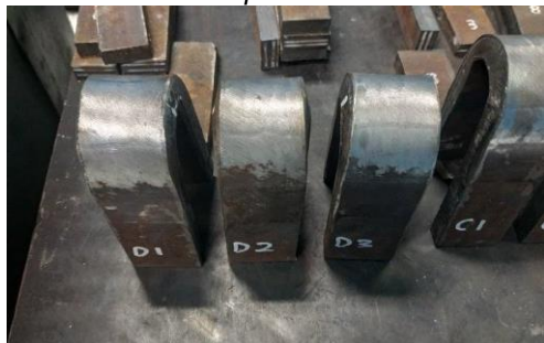
Gambar 22 Hasil uji bending pengelasan repair 3x
