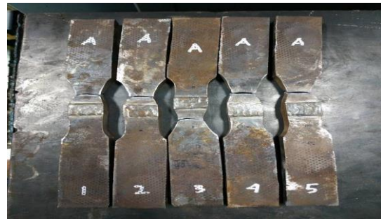
Gambar 15 Patahan uji tarik pengelasan Tanpa repair
