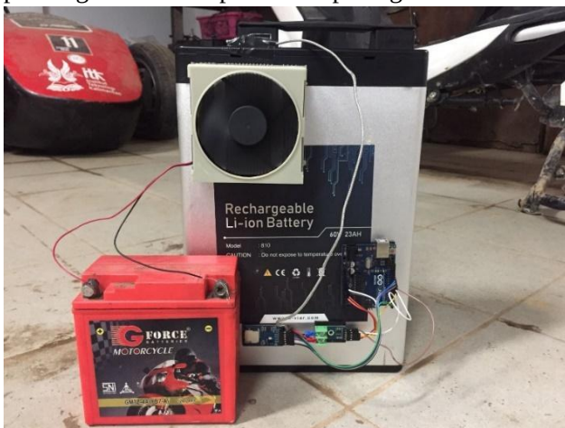
Gambar 5. Foto Rangkaian Pengukur temperatur dan Pendingin Baterai
