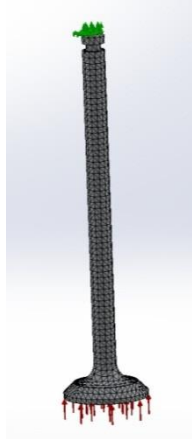
Gambar 4. Hasil Meshing pada desain katup
