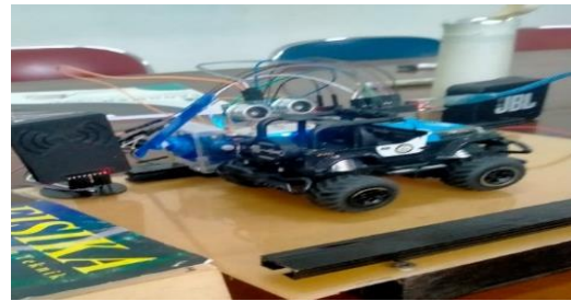
Gambar 10. Portal pintu setelah sensor ultrasonik mendeteksi objek melintas
