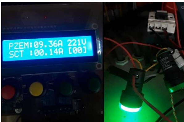
Gambar 8. Hasil pengujian pergerakan menggunakan indikator lampu
