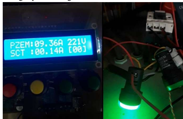
Gambar 7. Hasil pengujian pembacaan arus
