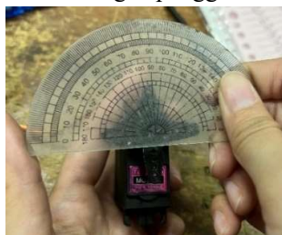
Gambar 12. Hasil pengukuran servo MG996R dengan penggaris busur.
