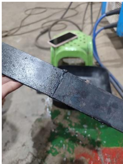
Gambar 3. Pemanasan kampuh V dengan las SMAW
