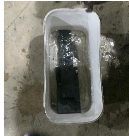
Gambar 4. Proses quenching spesimen menggunakan media air mineral
