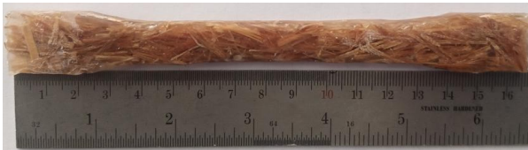
Gambar 6. Komposit Serat Pelepah Pisang dengan Fraksi Volume 50%
