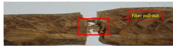
Gambar 8. Fiber Pull-Out yang Terjadi pada Specimen Komposit
