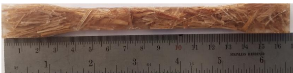
Gambar 7. Komposit serat pelepah pisang dengan fraksi volume 70%
