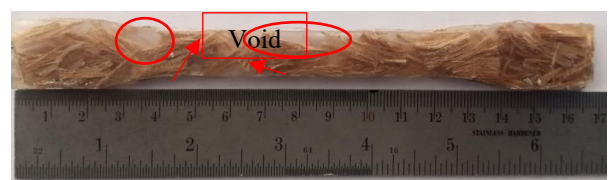
Gambar 5. Komposit Serat Pelepah Pisang dengan Fraksi Volume 30%
