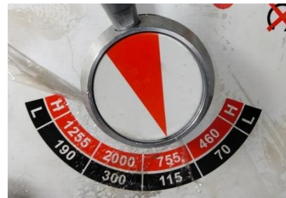
Gambar 9. Tabel Pengatur Kecepatan Putaran Spindle
