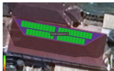
Gambar 4. Plotting Modul PV pada Skema North Roof
