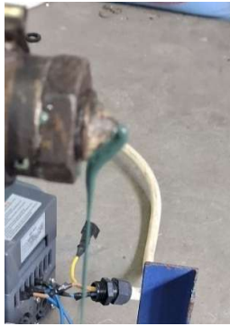
Gambar 2. Filamen Tidak Stabil yang Diekstrusi Hingga 180 °C
