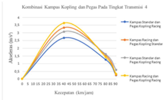
Gambar 6. Grafik Perbandingan Kombinasi Kampas dan Pegas Kopling pada Transmisi 4
