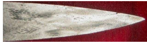
Gambar 6. Kawat Seling Setelah Proses Perlakuan Panas
